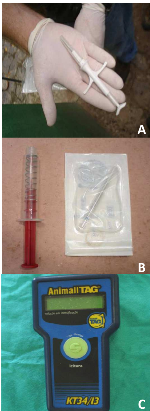
Figura 02: A. Implantador individual pronto para ser utilizado; B. implantador multiuso; C. Leitor modelo ISO 11784 FDX-B 134,2 KHz. Dênisson da Silva e Souza (Recife, 07/02/2010).
